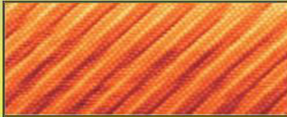
Atomes d'or observés au microscope à effet tunnel. (échelle: 1 cm représente 1,5 nm)
