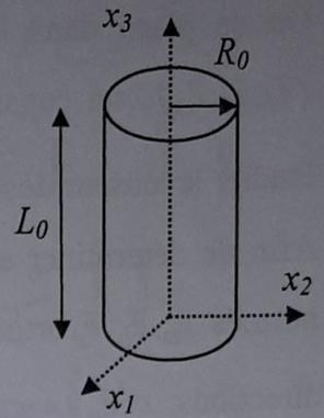
$$\begin{cases} u_1 = -\nu \frac{\sigma}{E} X_1 - \gamma X_2 + \beta X_3 + C_1 \\ u_2 = -\nu \frac{\sigma}{E} X_2 + \gamma X_1 - \alpha X_3 + C_2 \\ u_3 = \frac{\sigma}{E} X_3 - \beta X_1 + \alpha X_2 + C_3 \end{cases} \text{ où } \nu, E, \sigma, \alpha, \beta, \gamma, C_1, C_2 \text{ et } C_3 \text{ sont des constantes.}$$
