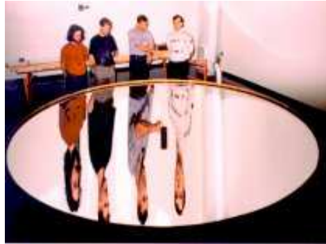
FIG. 3.5 – Miroir liquide de l'université Laval (Canada).
